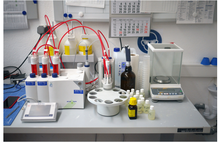
Automatische Titrationsanlage zur Bestimmung der Ätzmittelkonzentration
