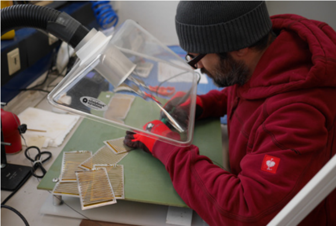
Verlöten der Anschlußleitungen mit der Aluminium-Leiterbahn
