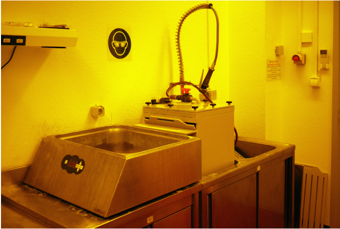
Anlage zur Entwicklung und Wässerung der belichteten Folie
