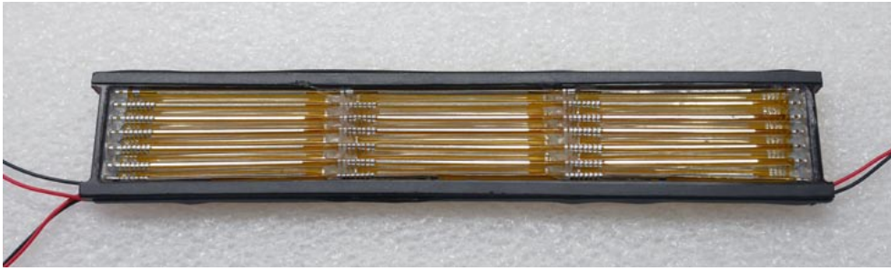
Bei dieser ProAMT-Membran sind sehr gut die drei individuell ansteuerbaren Bereiche erkennbar.
