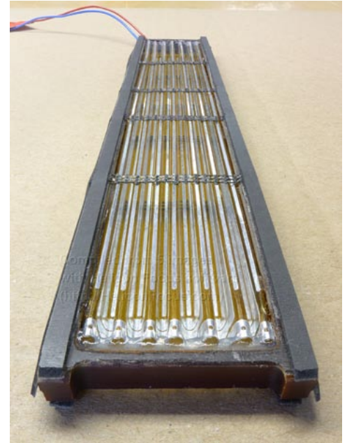
Membran eines ProAMT - deutlich zu erkennen ist die gefaltete Folie.
