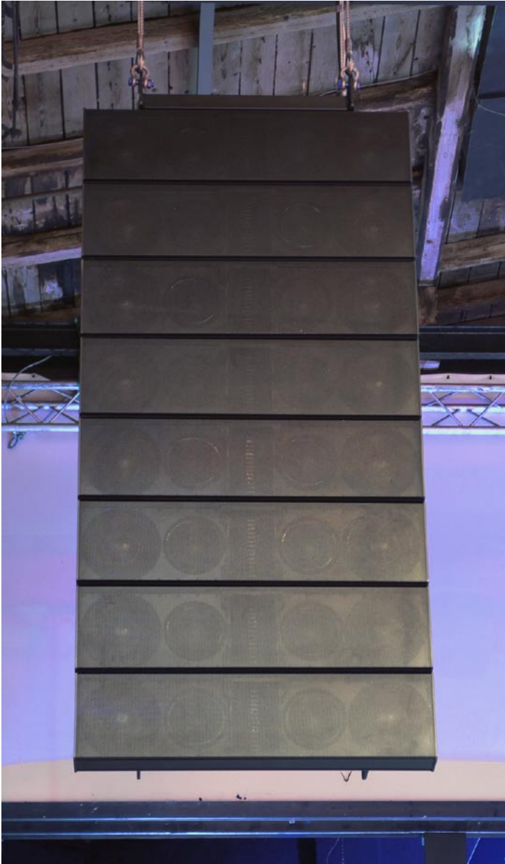
Frontansicht eines der Pan Beam Line-Arrays
