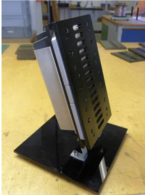
Mundorf ProAMT mit rückwärtiger Kammer und ohne vorgesetztes Horn.
